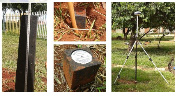
Figura 1 - Implantação do marco geodésico EAC03 no Campus da Universidade Federal de Uberlândia-Monte Carmelo/MG.
