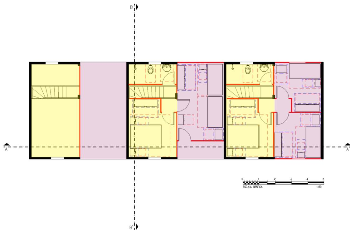
**Figura 4 – Planta do segundo pavimento que compõe as unidades duplex com possíveis modificações geradas no modelo BIM -**
